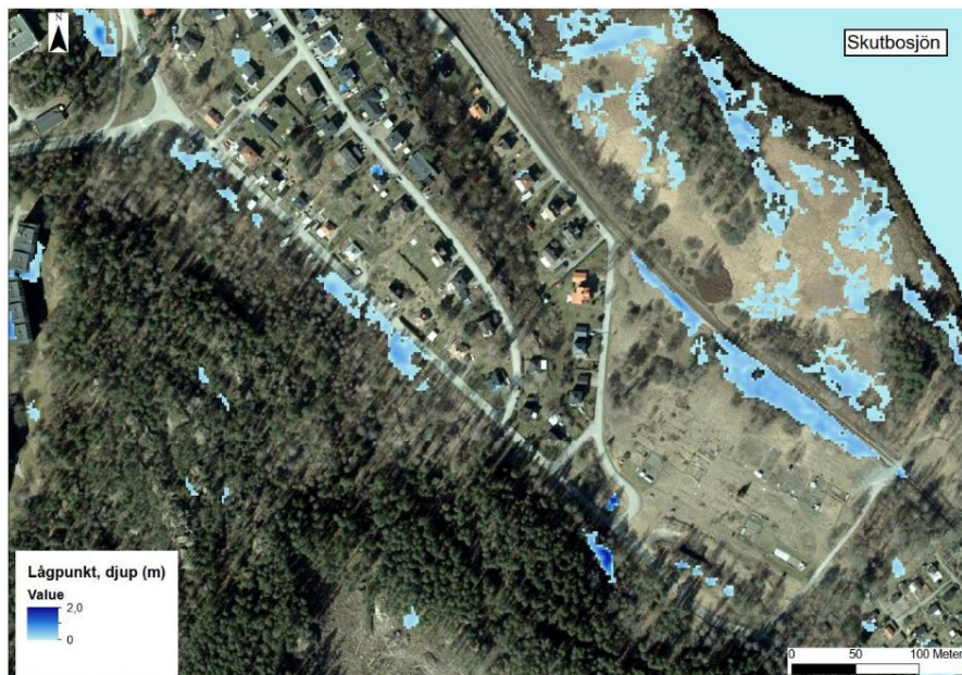
Lågpunkter längs med Sundsvägen och mellan Sundsvägen och järnvägsspåret (© Scalgo och Lantmäteriet)
